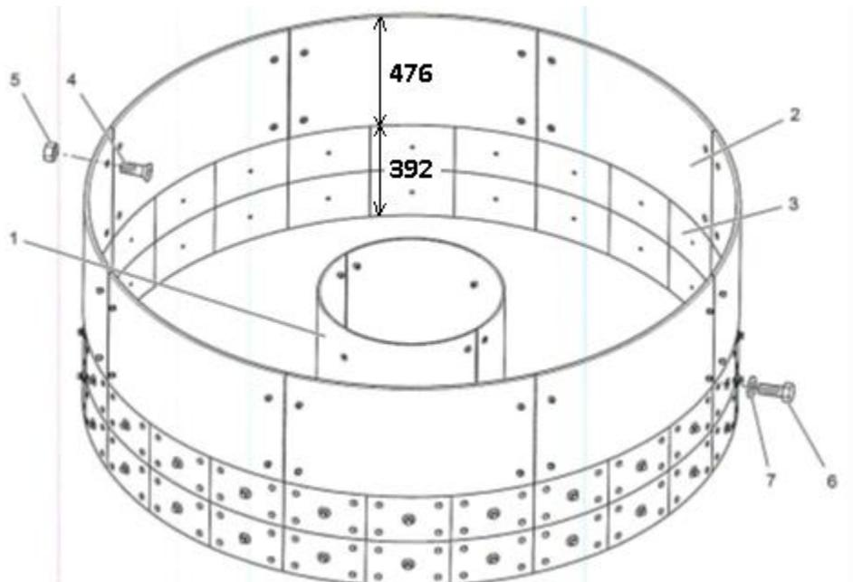
Элемент 1 стакана 93 34 799 05 – сталь 45, толщина 8 мм
